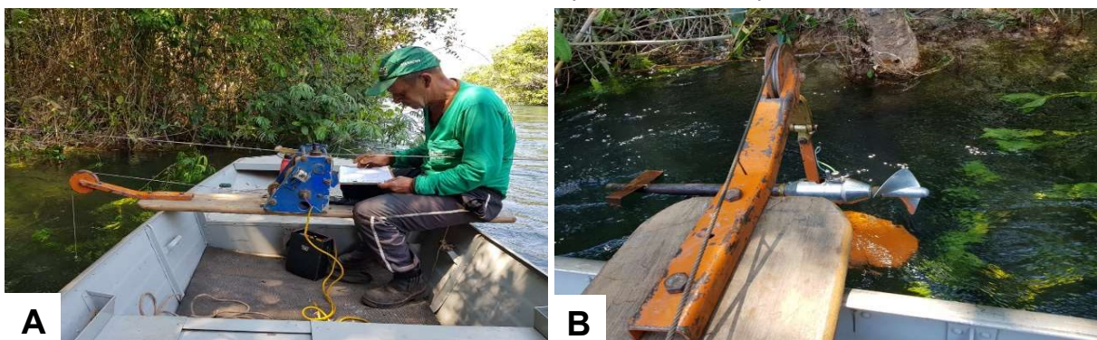
Figura 14. Vistas do guincho (A e B) e do molinete (B) utilizados para medir a velocidade da água nas diferentes profundidades da coluna d'água durante os estudos hidrossedimentológicos realizados na área de estudo do PACUERA da UHE Juruena, Campos de Júlio e Sapezal – MT.
