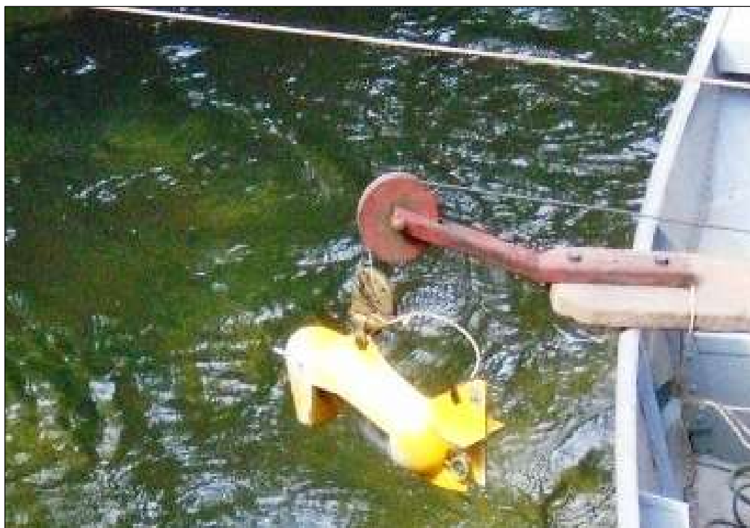
Figura 16. Vista do amostrador de sedimento em suspensão tipo garrafa, utilizado durante os estudos hidrossedimentológicos realizados na área de estudo do PACUERA da UHE Juruena, Campos de Júlio e Sapezal – MT.
